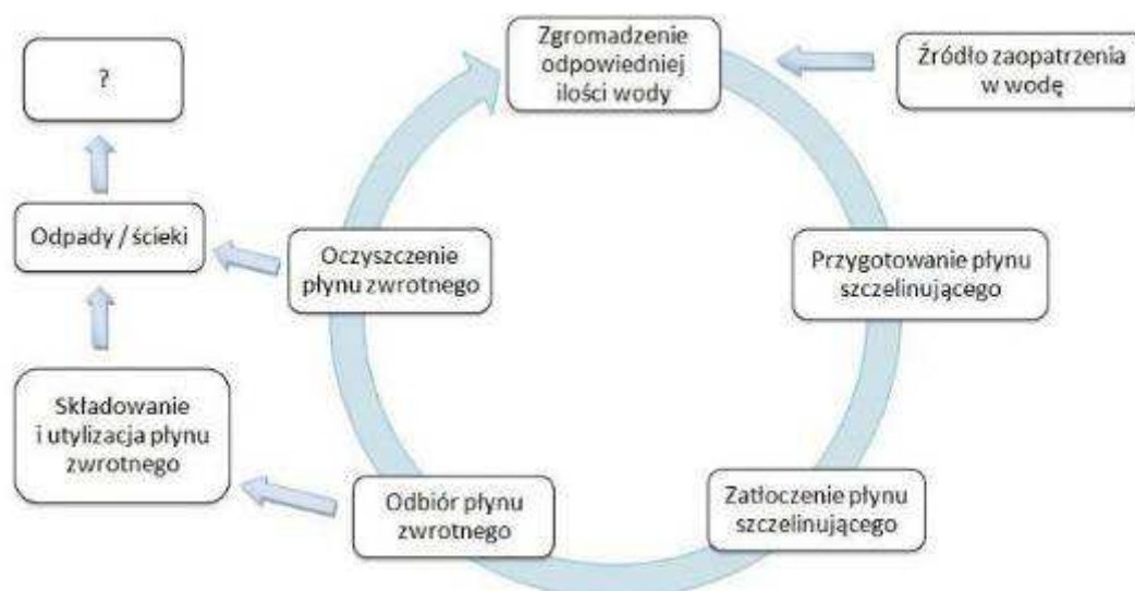
Rys. 6. Obieg wody w procesie szczelinowania hydraulicznego
